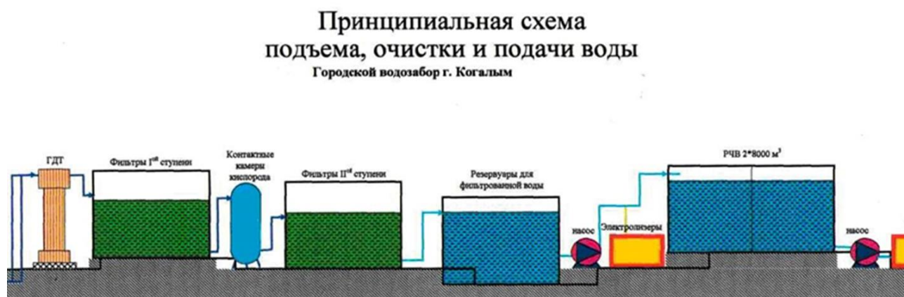
Рисунок 3. Принципиальная схема подъема, очистки и подачи воды
